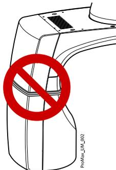
Запрещается прикасаться к металлическим деталям в центре трубки излучателя. Они могут нагреваться.
