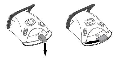
Нажмите педаль один раз для включения режима «вода + воздух». При этом раздаются два коротких звуковых сигнала.
