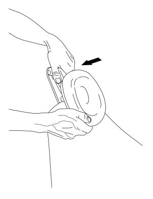
Теперь подголовник установлен в новое положение. Для регулировки угла подголовника нажмите на фиксирующий рычаг. Чтобы отрегулировать угол подголовника, нажмите на фиксирующий рычаг, установите подголовник в желаемое положение вручную и отпустите рычаг. При выполнении регулировки поддерживать подголовник другой рукой.
