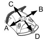
Педаль управления: нажать и быстро отпустить центральную кнопку педали управления в то положение (A, B, C или D), в котором хранится предварительно запрограммированное положение кресла. Кресло будет двигаться автоматически в предварительно запрограммированное положение.
