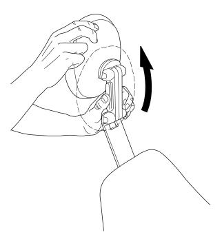
Нажмите на рычаг, расположенный сбоку на опоре подголовника. Освобождается фиксирующий механизм. Разместите подголовник в верхней части кресла.
