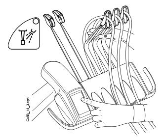
Сбалансированная верхняя подача инструментов: чтобы начать промывку, изогнуть рычаги инструментов, подлежащих промывке (включая шприц), под углом не менее 90° и одновременно нажать на панели управления кнопку Спрей инструмента (раздастся звуковой сигнал) и удерживать ее 3 секунды. Отпустите кнопку и рычаги, когда услышите второй сигнал.
