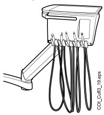
Держатели инструмента можно извлекать (например, для чистки), вытягивая их из отверстий. Чтобы вернуть держатель на место, его требуется просто установить до фиксации. Угол держателя инструмента можно слегка регулировать.
