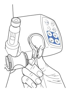
Извлеките дополнительный держатель, вытянув его из держателя Flexy. Чтобы вернуть его на место, просто нажмите до фиксации.
