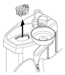
Дезинфицируйте держатель для промывки один раз в месяц в дезинфекторе при 93 °C или в автоклаве при 134 °C.
