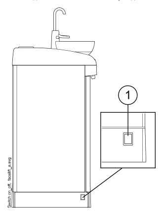
Когда установка включена, горит индикатор выключателя. На панели управления быстро отобразится версия ПО.
