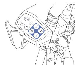
Извлеките ролик из держателя аспирационных шлангов, вытянув его из держателя. Чтобы вернуть его на место, просто нажмите до фиксации.
