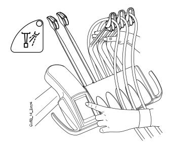
Сбалансированная верхняя подача инструментов: чтобы начать промывку, изогнуть рычаги инструментов, подлежащих промывке (включая шприц), под углом не менее 90° и одновременно нажать на панели управления кнопку Спрей инструмента (раздастся звуковой сигнал) и удерживать ее 6 секунды. Отпустите кнопку и рычаги, когда услышите второй и третий сигнал.
