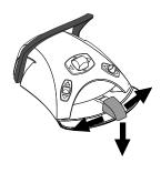
Чтобы запустить цикл полимеризации с помощью педали управления, сначала необходимо выбрать желаемый режим отверждения. Для этого нажать на кнопку навигации, расположенную на рукоятке инструмента. Затем запустить цикл полимеризации нажатием педали вправо, влево или вниз.
