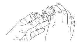
Извлеките держатель инструмента, нажав на него снизу и одновременно потянув вверх. Чтобы вернуть его на место, сожмите держатель и вставьте до фиксации.
