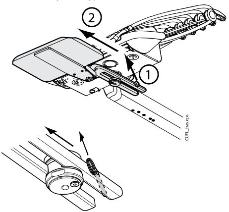
Установочный кронштейн можно прикрепить к инструментальной консоли, установив на место его крепления.
