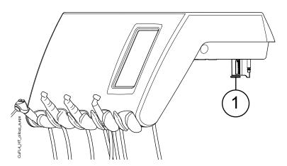
Чтобы снять маслосборник с инструментальной консоли, отвинтите крепежную ручку маслосборника и осторожно вытяните маслосборник.
